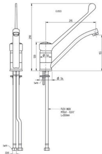
**Mischbatterie mit Schwenkhahn, für Einlochmontage mit Einhebelbedienung**
