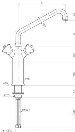
**Einloch-Mischbatterie, langes Standrohr, „C“-Auslauf**
