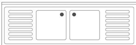
**Spülabdeckung mit 2 Becken und 2 Abtropfflächen / Sink cover with 2 sinks and 2 draining surfaces**
