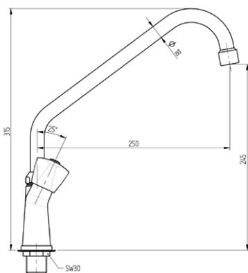
**Mischbatterie mit Schwenkhahn, für Zweilochmontage**
